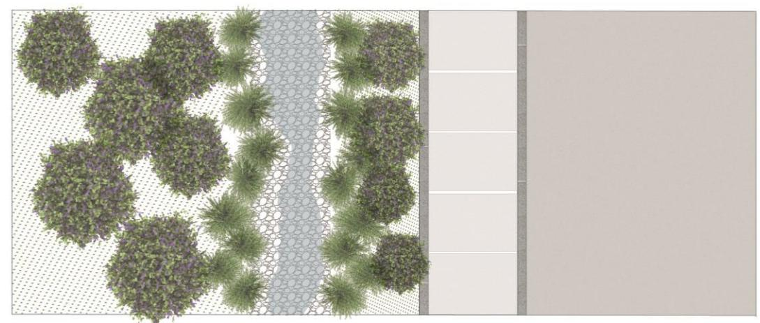
Adattamento delle aree verdi e dei marciapiedi per il collettamento delle acque : le aree verdi vengono adattate con l'inserimento di un fosso drenante e il ribassamento del terreno; ribassamento del marciapiedi a livello della strada; sostituzione del manto del marciapiedi con lastre scanalate in C.A. per l'incanalamento delle acque meteoriche verso l'area verde.
