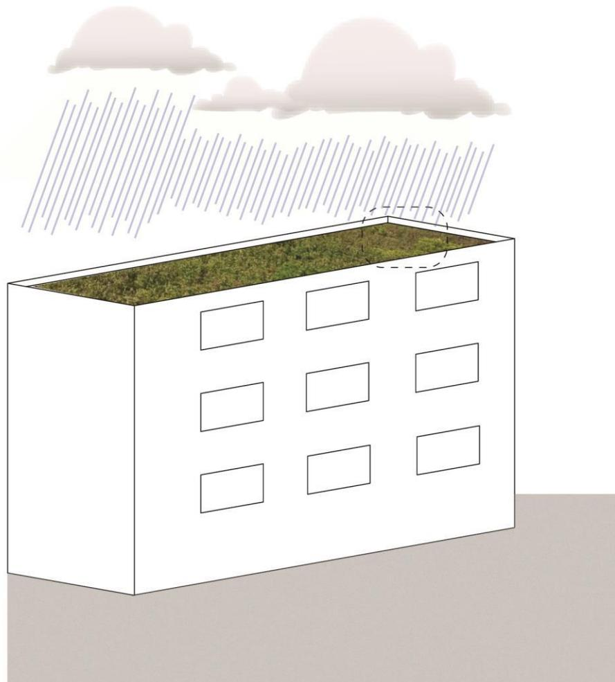
Realizzazione di tetto verde per il rallentamento delle acque meteoriche: soletta verde estensiva su copertura esistente piana o inclinata
