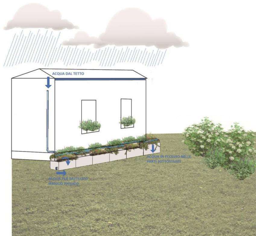
Realizzazione di cisterne- fioriere per la raccolta e riutilizzo delle acque meteoriche provenienti dalle falde dei tetti: le cisterne hanno dimensioni modulari di h 1 m e profondità 0,6 m per le maggiori, h 0,6 m e profondità 0,6 m per le minori e vengono disposte alla base delle pareti perimetrali non interessate da aperture e elementi sporgenti, per un totale di circa 20/25% dei perimetri totali degli edifici.
