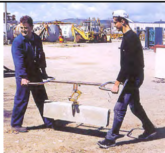
Pinza meccanica per trasporto manuale a due persone
