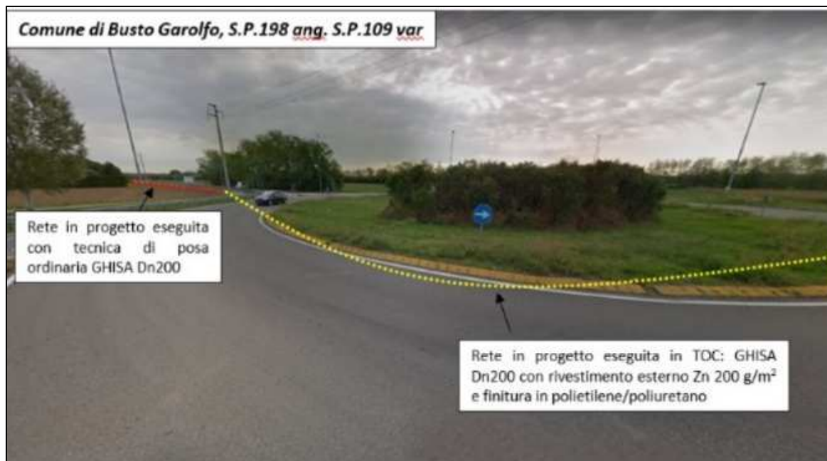
Tratta da posare con TOC in S.P.198
