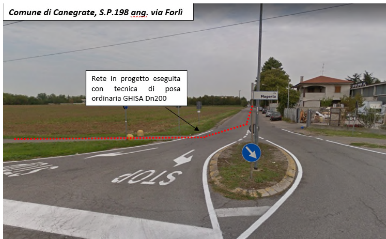
Figura 5.6 – Tratto da posare con scavo a cielo libero su pista ciclabile in fregio alla S.P.198
