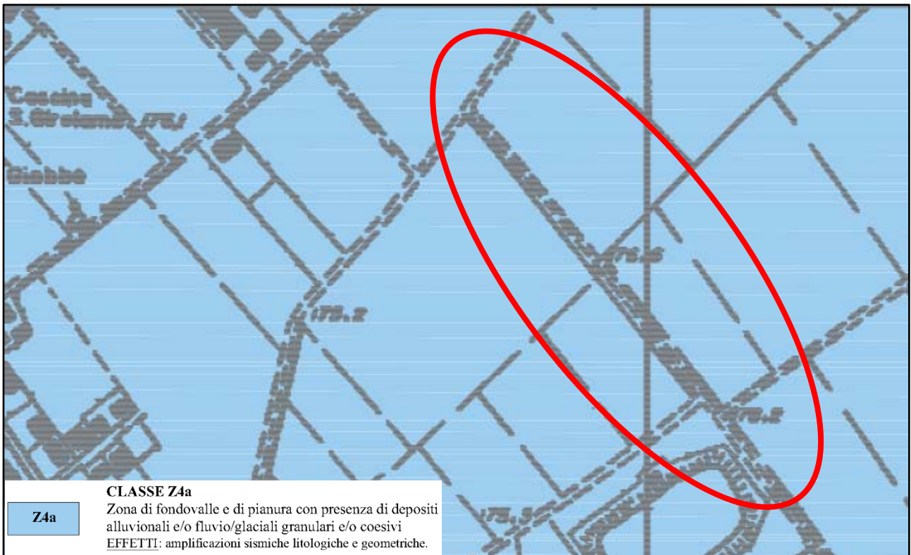
Figura 2. Carta di pericolosità sismica locale, scala 1:5000
