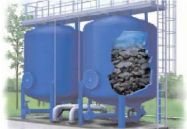
*Figura 1 - Filtri a carbone attivo granulare*
