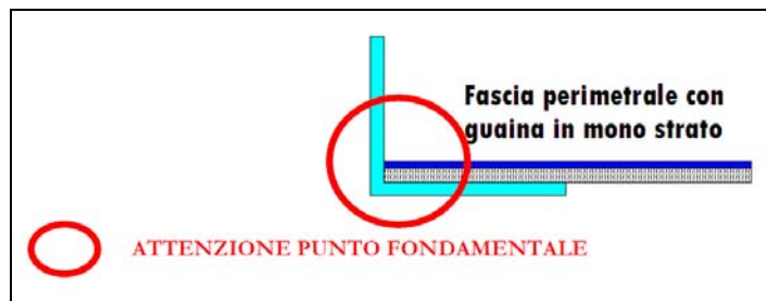
Figura 16 - Dettagli di posa
