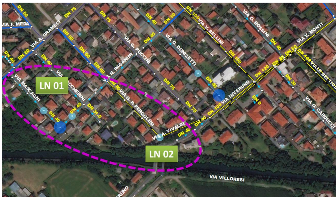
Figura 10: Risultato del modello idraulico per TR 2 anni nell'ipotesi di progetto LN01 e LN02
